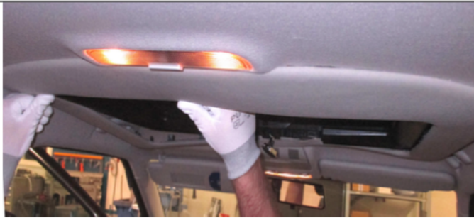
トリムシェルの所定の位置にクランプを押し込んでください。
