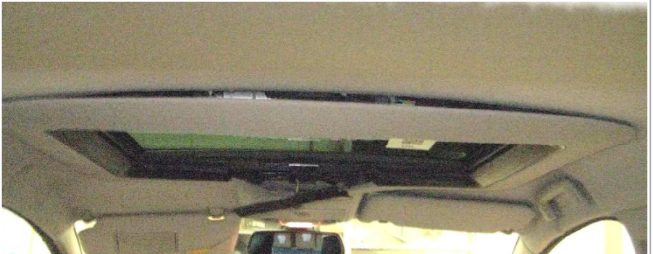
上の写真はトリムシェルにブラケットを取り付けていない時の状態です。
