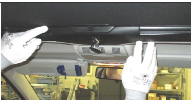
スイッチカバーを取付けてください。
