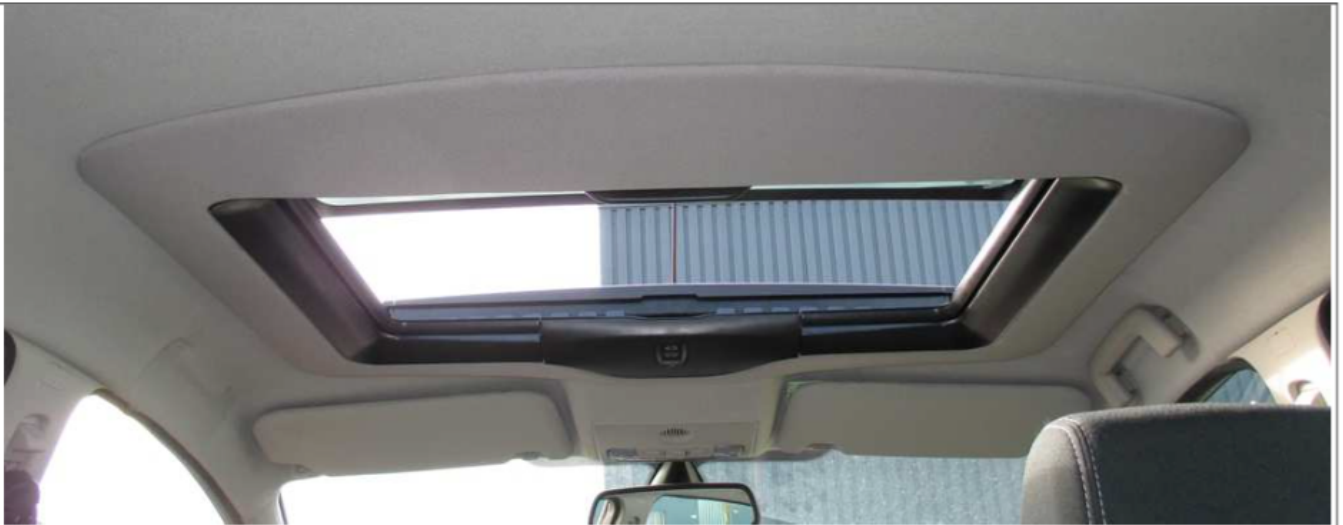
上の写真は「Ford (Fiesta)」の後側から見たH300トリムシェル仕上です。 トリムシェルにブラケットを取り付けて仕上げてあります。
