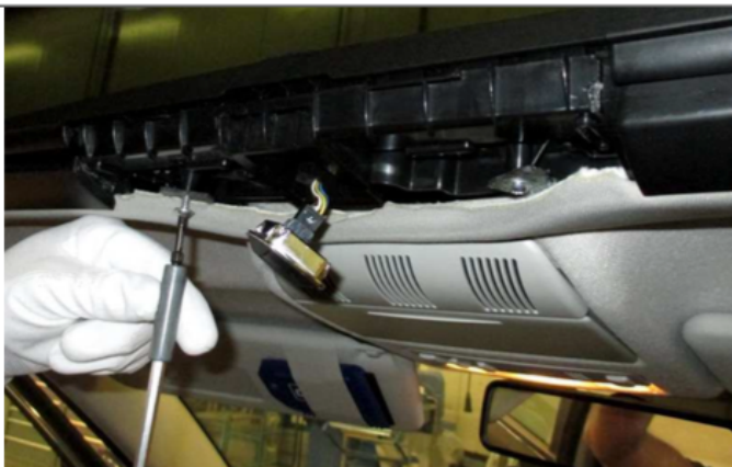
トリムシェル前方のネジ（2本）を締め付けてください。
