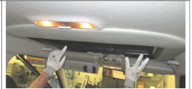
フロント部のクランプを押し入れて完了です。
