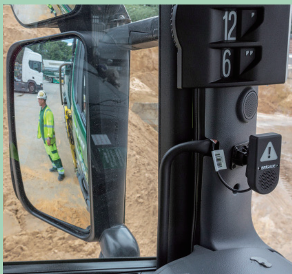
車の進行方向にない静止物体 ＝ドライバーへの警告なし
