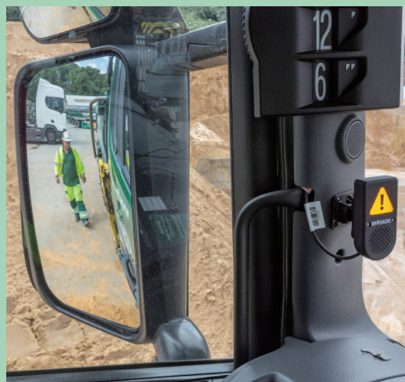
車の進行方向にない移動物体 ＝黄色の視覚警告。警告音なし
